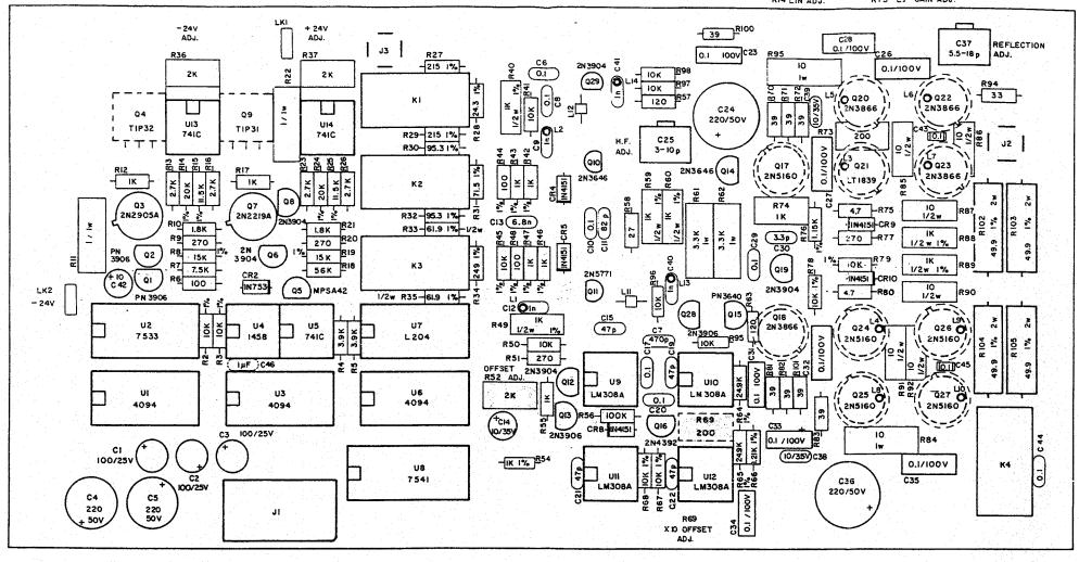
Q17, Q18,Q20-027 MOUNTED ON HEATSINK ON OPOSITE SIDE OF THE BOARD.
